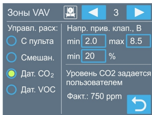
К зоне модуля подключён датчик углекислого газа
